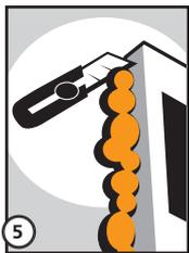
5. Der Schaum härtet durch Luft- und Umgebungsfeuchtigkeit aus. Der Schaum lässt sich im frischem Zustand nicht schneiden er breitet sich selbständig aus und füllt die Hohlräume. Maximal maximal bis zur Hälfte des zu füllenden Hohlraumes dosieren. Nach der Durchhärtung die überstehende Menge abschneiden.
