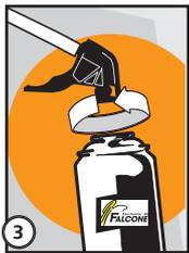
3. Schutzkappe abnehmen (Schutzhandschuhe ggf. verwenden, diese befinden sich in der Schutzkappe), Adapter auf das Ventil drehen. Dose mit dem Ventil nach unten halten und mit dem Ausschäumen beginnen.
