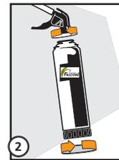
2. Die Dositemperatur muss mindestens +10° C, maximal +25° C betragen. Über +25° C Dose nicht aktivieren - Berstgefahr durch Reaktionswärme! Schutzkappe abnehmen, Adapter aufschrauben. Teller am Dosenboden ca. 6 mal in Pfeilrichtung drehen.
