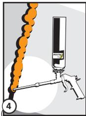
4. Bei täglichem Gebrauch Behälter an der Schaumpistole angekoppelt lassen. Erst bei vollständigem Verbrauch kann die Dose entfernt werden. Austretenden Schaum von Ventil und Gewinde gründlich mit Falcone PU-Schaumreiniger entfernen. Anschliessend sofort eine neue Dose aufsetzen, da sonst die Schaumpistole verklebt. Durch die Pistolenverarbeitung ist das sparsame Dosieren des Schaumes leichter möglich.
