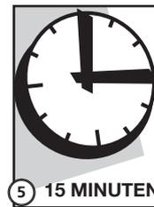
5. Wärmeentwicklung zeigt fortschreitende Reaktion an. Die Entleerung muss in circa 8 Minuten abgeschlossen sein. Dose immer vollständig entleeren.
