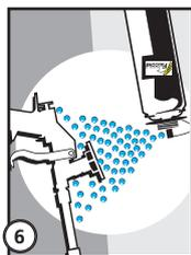
6. Immer eine Dose auf der Pistole montiert lassen! Sollte die Dose weniger als Zur Pistolenreinigung verwenden Sie Falcone Pistolenschaumreiniger. Sparen Sie nicht! Gut und lange durch sprühen. Niemals die Dose mit Gewalt vom Adapter entfernen.
