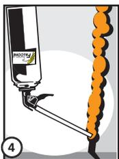
4. Sparsam dosieren! Der Schaum wächst ca. um das 2-3fache nach. Das Kippventil wird durch Fingerdruck auf den Adapter geöffnet und durch diesen reguliert.
