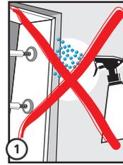
1. Der Untergrund muss frei von losen Teilen, fest, staub- und fettfrei sein. Die Elemente sind nach Vorschrift auszurichten, zu verkeilen und zu montieren. Angrenzende Flächen abdecken (z.B. mit Falcone Abdeckband). Untergrund NICHT anfeuchten! Falcofoam 2K Montageschaum härtet unabhängig von Feuchtigkeit aus.
