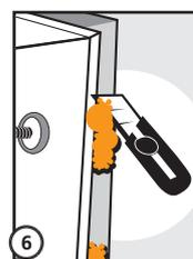
6. Den Schaum in frischem Zustand nicht schneiden oder verstreichen, er breitet sich selbständig aus und füllt die Hohlräume. Nach Aushärtung des Schaumes (ca. 20 Min.) kann man durch Schneiden oder Sägen Korrekturen vornehmen. Der Schaum erreicht seine volle Belastbarkeit nach ca. 2h.
