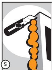
5. Der Schaum härtet durch Luft- und Umgebungsfeuchtigkeit aus. Den Schaum lässt sich in frischem Zustand nicht schneiden er breitet sich selbständig aus und füllt die Hohlräume. Nach der Durchhärtung die überstehende Menge abschneiden.
