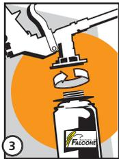
3. Schutzkappe abnehmen (Schutzhandschuhe ggf. verwenden, diese befinden sich in der Schutzkappe). Die Schaumdose mit dem schwarzen Dosenadapter leicht bis zum Anschlag auf die Pistole schrauben. Den Behälter dabei nicht verkannten oder überdrehen. Anschliessend mit dem Ausschäumen beginnen.
