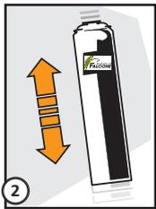
2. Die Dose vor Gebrauch kräftig schütteln (auch nach kurzer Arbeitsunterbrechungen)! Die Dositemperatur muss mindestens +15° C, maximal +25° C betragen. Die Aussentemperatur muss mindestens +5° C, maximal +35° C betragen.
