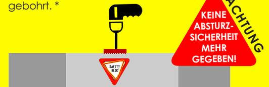
Ab der ersten Bohrung im **SAFETY BLOC 120**, unabhängig von Größe, Abstand oder Durchmesser ist keine Durchtrittsicherheit mehr gegeben!
